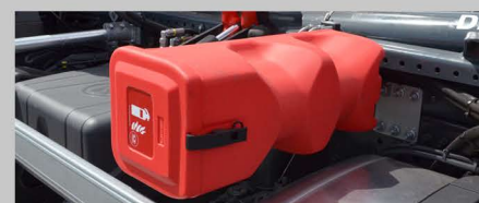
EXTINCTEUR 6 KG DANS COFFRE PVC
