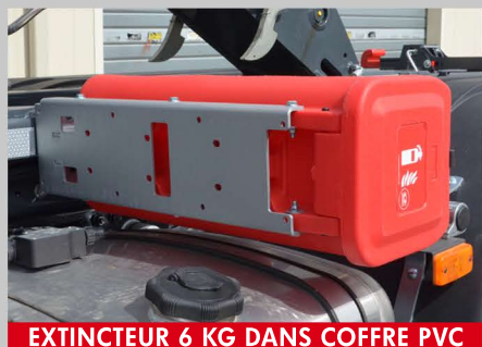
EXTINCTEUR 6 KG DANS COFFRE PVC
